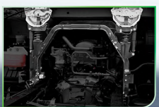
Hệ thống treo cabin toàn phần (FVM/FVZ) (Mới) Full-floating cab suspension system (FVM/FVZ) (New)
